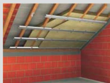
3. Поставете допълнителният слой изолация, плоскостите от каменна (минерална) вата **Knauf Rock KR S**, между носещ елемент на подконструкцията
