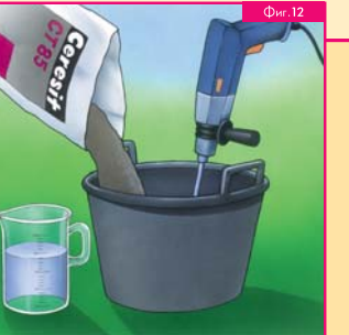
Лепилният разтвор се изсипва в предварително измереното количество чиста хладка вода. Съотношението на смесване: CT 83 - 5,25 l за 25 kg продукт CT 85 - 6,6-5,1 за 25 kg продукт CT 87 - 7,25-7,75 l за 25 kg продукт
