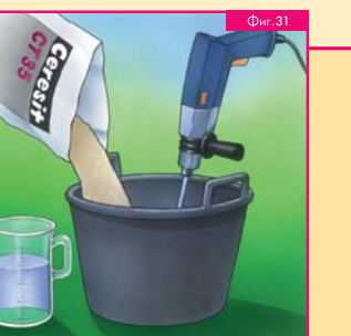
Към окончателното завършване на фасадата може да се пристъпи около 3-5 дни след изпълнение на армирания слой и грундирането му с Ceresit CT 16. Декоративните мазилки са готови за употреба и само се разбъркват преди употреба. Една стена (плоскост) трябва да се обработва на един работен цикъл, а мазилката трябва да бъде с един и същ серийен номер на производство, отбелязан на всяка опаковка.
