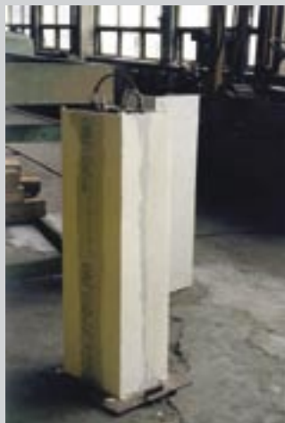
Образци от изпитване на НПИПАБ - преди и след изпитването
