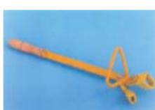
YTONG-каналокопател за изстъргване на канали в стените за ВиК и ел. инсталации
