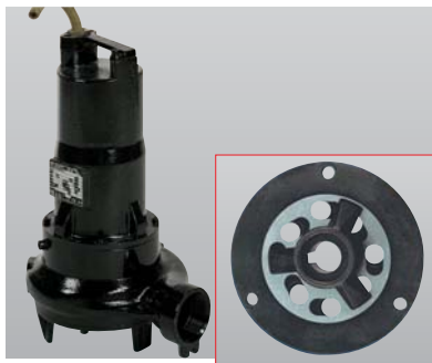
Потопяема помпа SITA. Странично разположения помпен лагер (в дясно), гарантира пълен диаметрален поток. Това го прави подходящо за силно замърсени води или съдържащи влакна отпадни води.
