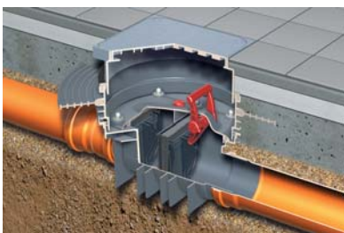
ACO TRIPLEX-K-2 двойна клапа против обратно връщане на водата, DN 100 тип 2 съгласно БДС EN 13564 за инсталация в подова плоча
