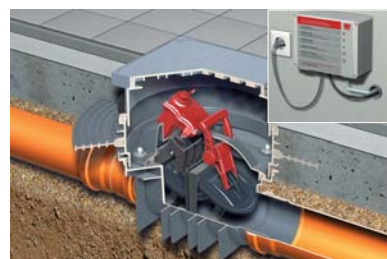
Автоматична клапа против обратно връщане на води със съдържание на фекалии ACO QUATRIX-K, DN 100, тип 3F съгласно БДС EN 13564 за инсталация към подови тръби
