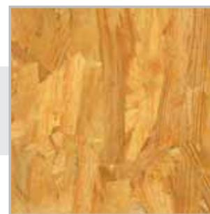
**Кроношпан OSB 3** се произвежда съгласно предписанията на EN 300. Техническите показатели на плоскостите покриват напълно изискванията за носещи конструкции във влажна среда. /тип OSB 3/
